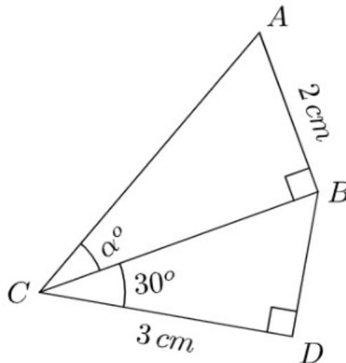
Pour calculer l'angle  $\alpha^\circ$ , il nous faut utiliser la trigonométrie dans le triangle ABC. Mais il nous manque une seconde longueur pour ça. On se propose donc de calculer la longueur BC.
