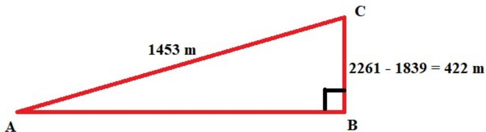
Dès lors, pour calculer l'angle de la pente, il nous suffit de calculer l'angle  $\widehat{BAC}$ .
